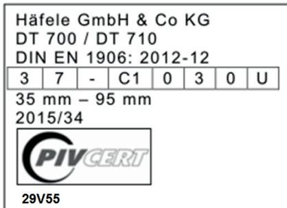
**6.2 已按 DIN EN 12209: 2004-03 + Ber.1: 2006-06 标准试验** DT 700/710: 所有版本已按 **DIN EN 12209:2004-03 + Ber.1: 2006-06** 试验。
