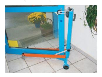
3. Die Tür oder Platte nun mit den beiden Klemmbacken sichern: den linken Klemmbacken anlegen und den rechten Klemmbacken mit der Gewindespindel nach links zudrehen, indem man den rechten Griff im Uhrzeigersinn dreht.
