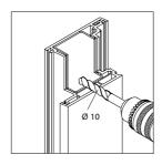
Von der Griffseite mit 10 mm Bohrer bohren.
