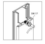
Unterlegscheibe auf selbstschneidende Spezialschraube aufstecken.
