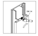
Unterlegscheibe auf selbstschneidende Spezialschraube aufstecken.
